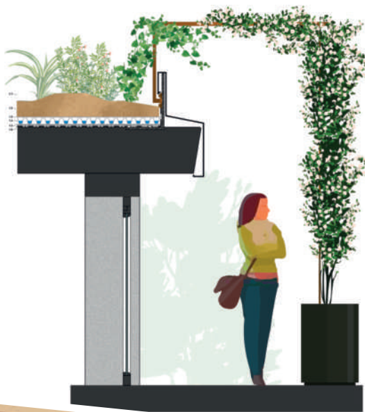
Stratigrafia del sistema Harpo verdepensile
