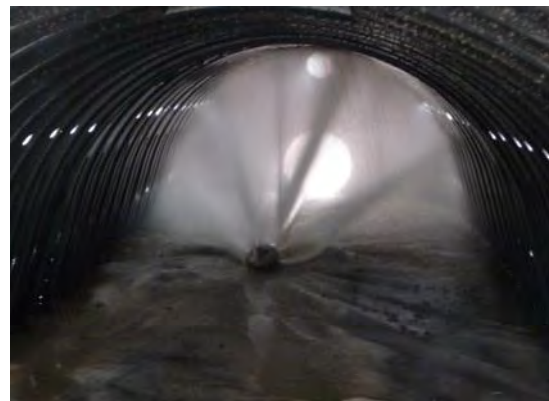
Immagine 3: Ugello di lavaggio con getti conici inversi Immagine 4: Ugello di lavaggio con procedura di pulizia
