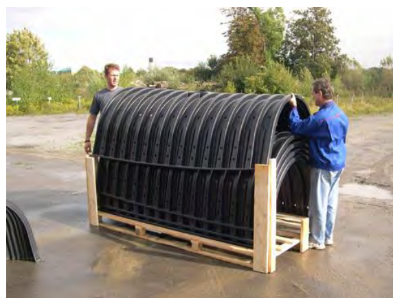
Immagine 1: Trasporto su pallet degli elementi di tunnel Immagine 2: Sollevamento degli elementi
