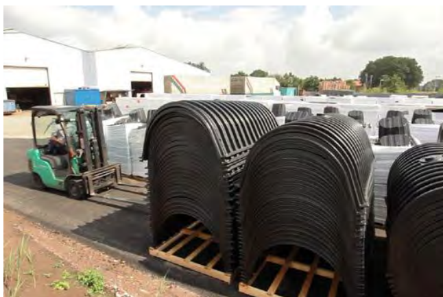
Immagine 1: Trasporto su pallet degli elementi di tunnel Immagine 2: Sollevamento degli elementi
