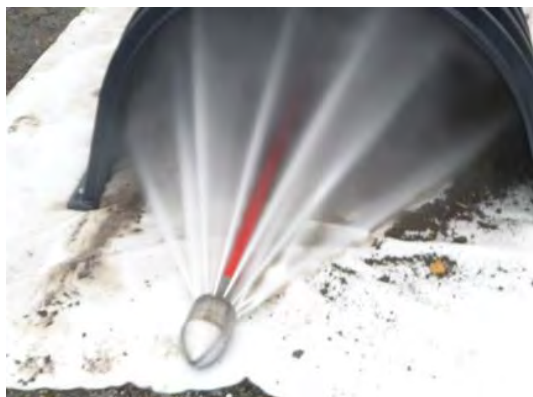
Immagine 3: Ugello di lavaggio con getti conici inversi Immagine 4: Ugello di lavaggio con procedura di pulizia
